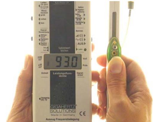
Zum Verschieben hält man das Filter fest in der rechten Hand und „unterstützt“ das Messgerät nur leicht mit der linken Hand. Das eigentliche Verschieben des Schlittens erfolgt dann nicht „freihändig mit der ganzen Hand“, sondern während die rechte Hand das Filter fixiert, wird der Schlitten nur mit dem Daumen nach oben oder unten verschoben. Der Daumen liegt dabei nicht von oben auf dem Schlitten, sondern jeweils auf dem unteren oder oberen Ende des Schlittens, damit er nicht abrutscht.
