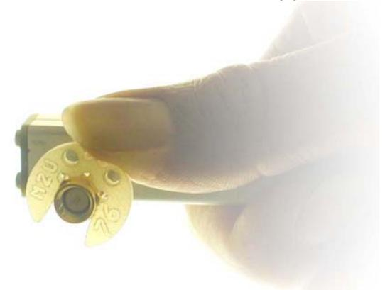
Das am unteren Verschlussstück des Filters nach rechts überstehend angeschraubte Leiterplattenstück dient nur zur evtl. Kaskadierung mehrerer Komponenten. Wenn dieses als störend empfunden wird, kann es problemlos abgeschraubt werden.
