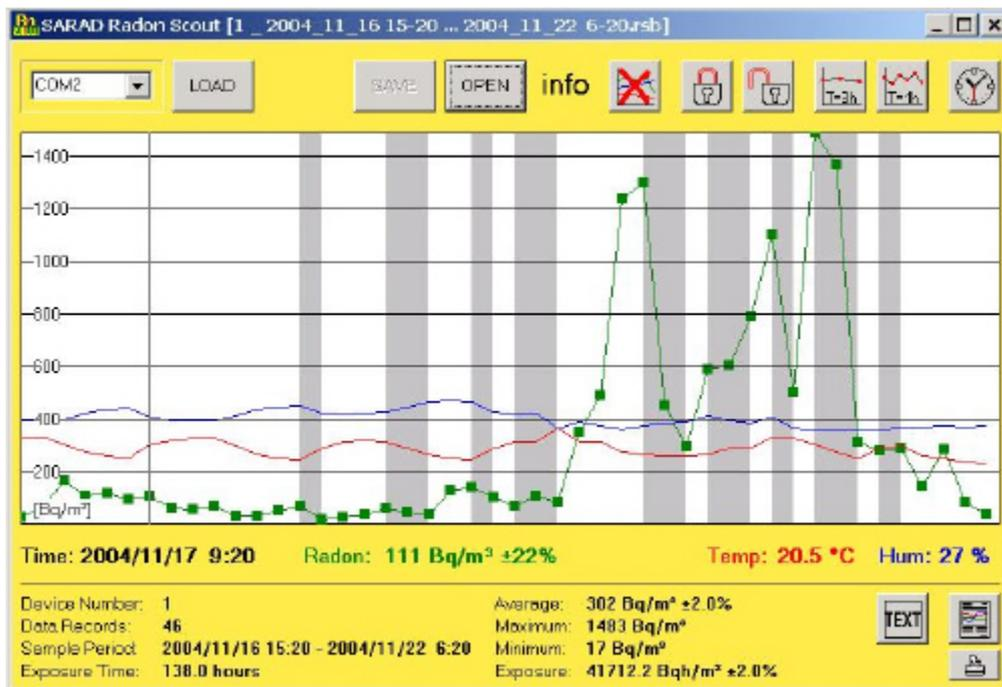
Bei Radonkonzentrationen oberhalb des derzeit für die Durchführung von Sanierungsmaßnahmen empfohlenen Richtwertes von  $400\text{Bq/m}^3$  kann mit einem Integrationsintervall von einer Stunde gearbeitet werden, so dass auch kurzzeitige Schwankungen gut zu sehen sind.
