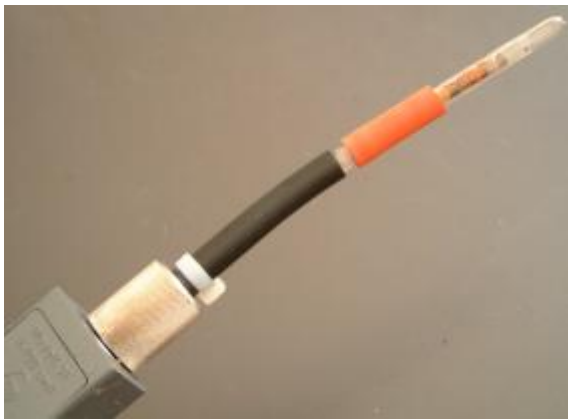
Schlauchanschluss an Pumpe
