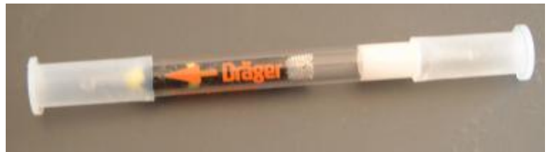
NIOSH-Röhrchen zur Lösemittelmessung
