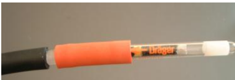
Anschluss Probenahmeröhrchen mit Durchflussadapter (orange) am Schlauch (Pfeil zeigt in Richtung Pumpe)
