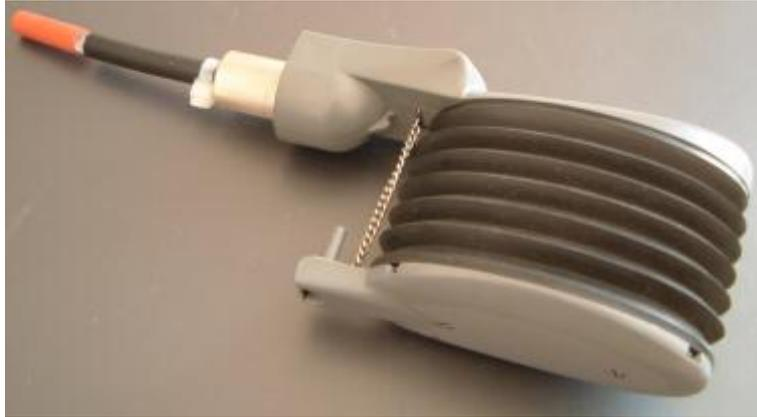
Probenahmepumpe (Pumpenart kann leicht variieren)
