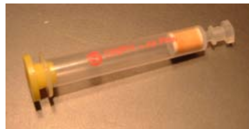
DNPH Kartusche zur Formaldehydmessung
