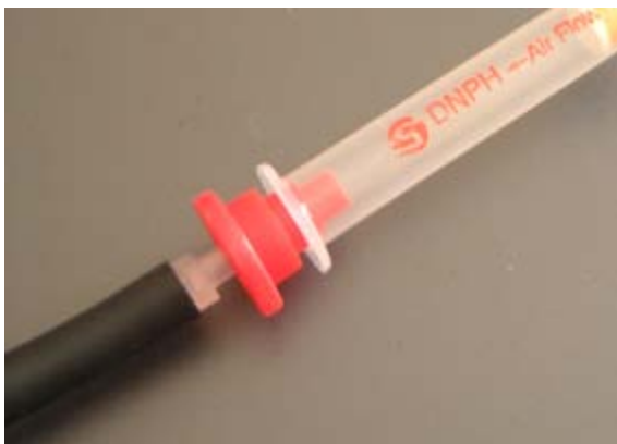
Anschluss Probenahmeröhrchen mit Adapter am Schlauch
