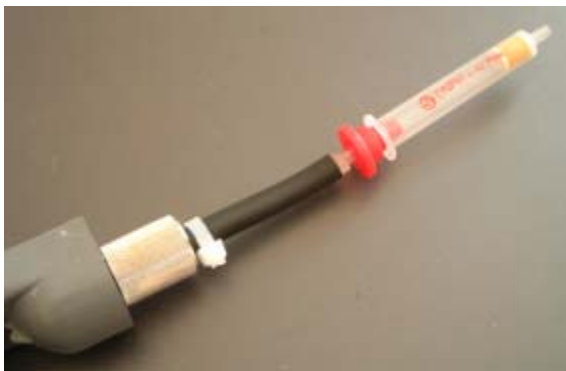
Schlauchanschluss an Pumpe
