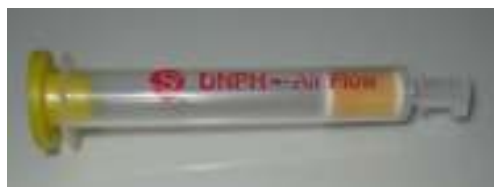
DNPH Kartusche zur Formaldehydmessung
