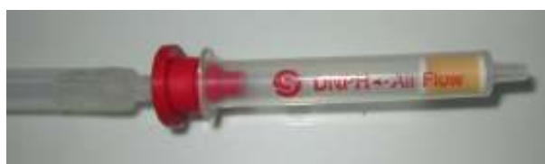
Röhrchenanschluss an Pumpe
