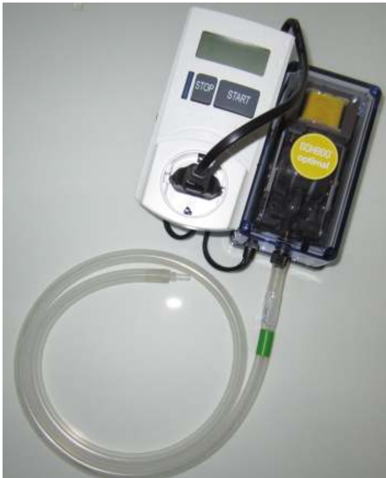
Timer + Probenahmepumpe (Pumpenart kann leicht variieren)
