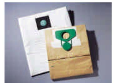
Sauger, die gesundheitsgefährliche Stäube abscheiden sollen, verfügen oft über eine Kombination aus verschiedenen Filtertypen. Man spricht dann von einem Filtersystem. Sicherheitssauger der Nilfisk-Advance AG halten den Normalstaub mit einem Textilfilter zurück und filtern die extrem feinen Partikel über ein HEPA-Filter heraus. HEPA steht für **Hoch-Effiziente Partikel-Abscheidung**.
