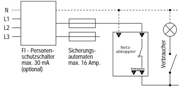
Vor dem Einbau Vorsicherung ausschalten. Eingang "N" mit der Neutralleiterschienen und Eingang "L" mit dem Ausgang des relevanten Sicherungsautomaten verbinden. Vorsicherung einschalten.
