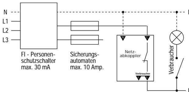
Vor dem Einbau Vorsicherung ausschalten. Eingang "N" mit der Neutralleiterschiene und Eingang "L" mit dem Ausgang des relevanten Sicherungsautomaten verbinden. Vorsicherung einschalten.
