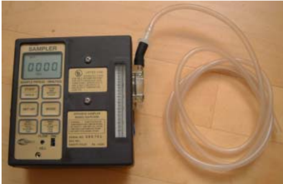
Probenahmepumpe mit angeschlossenem Schlauch
