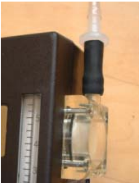
Schlauchanschluss an Pumpe
