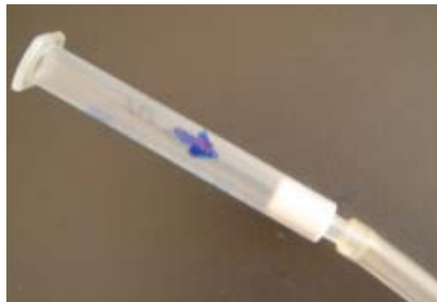
Anschluss Probenahmeröhrchen an Schlauch
