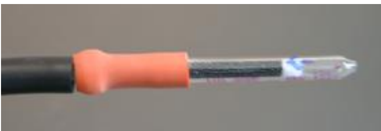
Anschluss Probenahmeröhrchen mit Durchflussadapter (orange) am Schlauch (Pfeil zeigt in Richtung Pumpe)
