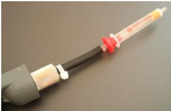
Schlauchanschluss an Pumpe
