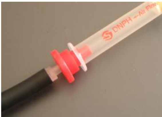
Anschluss Probenahmeröhrchen mit Adapter am Schlauch
