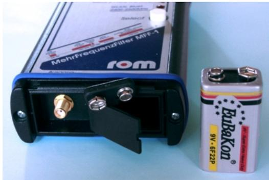
**Batteriefach und Anschluss zum HF-Messgerät**
