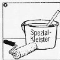
Diesem Kleisteransatz noch 10-20 % Dispersionskleber (z. B. Ovalit T) zugeben und einrühren. Dann ist der Kleister gebrauchsfertig.
