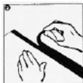
Jetzt die zugeschnittene Bahn mit der Vorderseite nach innen (bahnvorderseitig sind die sichtbaren schwarzen Bahnkantenstreifen) aufrollen.
